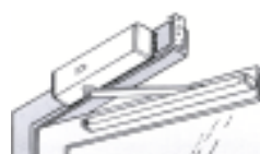
Suljin sulkeutumispuolella liukuvetolaite ovilehteen asennettuna.
